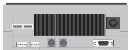
De aansluitmogelijkheden aan de achterkant van de Intellibox
