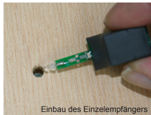
Einbau des Einzelempfängers
