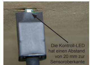
Einbau des Einzelempfängers
