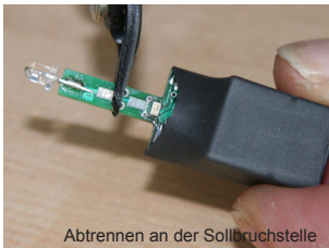
Abtrennen an der Sollbruchstelle
