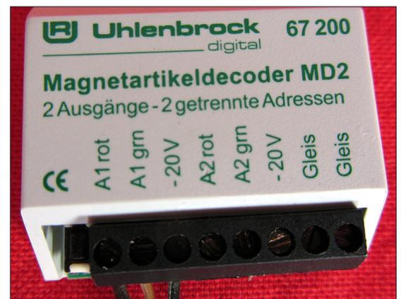
Uhlenbrock (67200) Magnetartikeldecoder zum Anschluß von 2 Weichen oder 4 Entkupplungsgleisen
