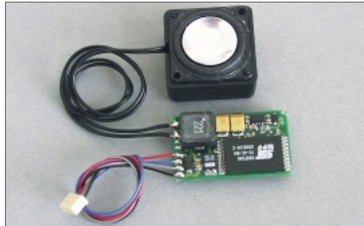
Uhlenbrock Soundmodul 32000 zur Nachrüstung aller Lokdecoder mit SuSi-Schnittstelle.
