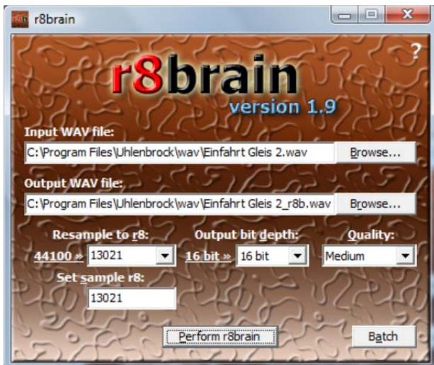
Nachdem das wav-file geladen ist, wird die Samplerate dieses files links unter „Resample to r8:“ angezeigt. Hier im Beispiel 44100Hz. In dem Feld daneben, muss nun die Wunsch samplerate von 13021Hz eingegeben werden. Dieser Wert wird im Feld „Set sample r8:“ übernommen. Danach nur noch die Schaltfläche „Perform r8brain“ betätigen und das neue wav-file wird erzeugt.
