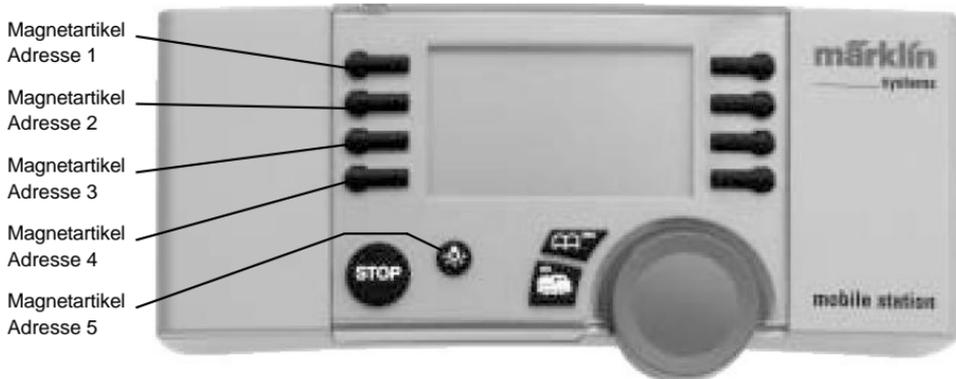
Die Magnetartikel können über die Sonderfunktionstasten geschaltet werden. Hat der Magnetartikel die Stellung „rund“ oder „rot“ und die Taste wird einmal betätigt, so schaltet der Magnetartikel in die Stellung „gerade“ oder „grün“ und umgekehrt. Die Stellung des Magnetartikel kann an der mobile station nicht abgelesen werden.
