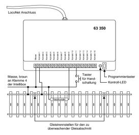
Befindet sich ein Fahrzeug im Überwachungsabschnitt, so verbinden die Achsen des Fahrzeugs den Überwachungseingang mit Masse und das Gleis wird als belegt gemeldet.
