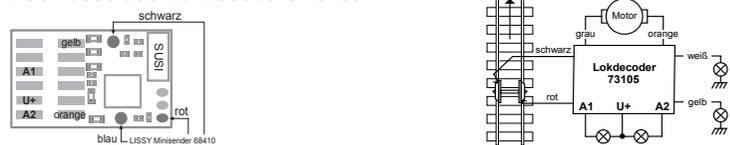
Schließen Sie die rote Leitung des Decoders an den rechten Radstromabnehmer und die schwarze Leitung an den linken Radstromabnehmer an. Die orange und die graue Leitung des Decoders löten Sie an die beiden Motoranschlüsse. Probieren Sie aus, ob die Fahrtrichtung stimmt. Wenn nicht, müssen die orange und die graue Leitung gegeneinander getauscht werden. **WICHTIG:** Die Entstörelemente verbleiben am Motor.
