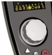
Das Drehen des Fahrreglers dient zur Änderung der Lokgeschwindigkeit. Ein Druck auf den Fahrregler führt zu einem Nothalt der aktuellen Lok und, bei gewähltem AC - Fahrreglermodus (Werkseinstellung), zur Umkehr der Fahrtrichtung.
